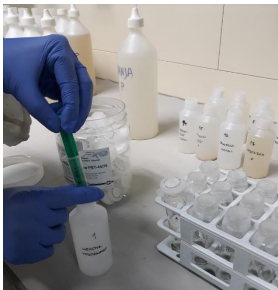
Slika 4.1.1. Uzimanje uzoraka za filtriranje
