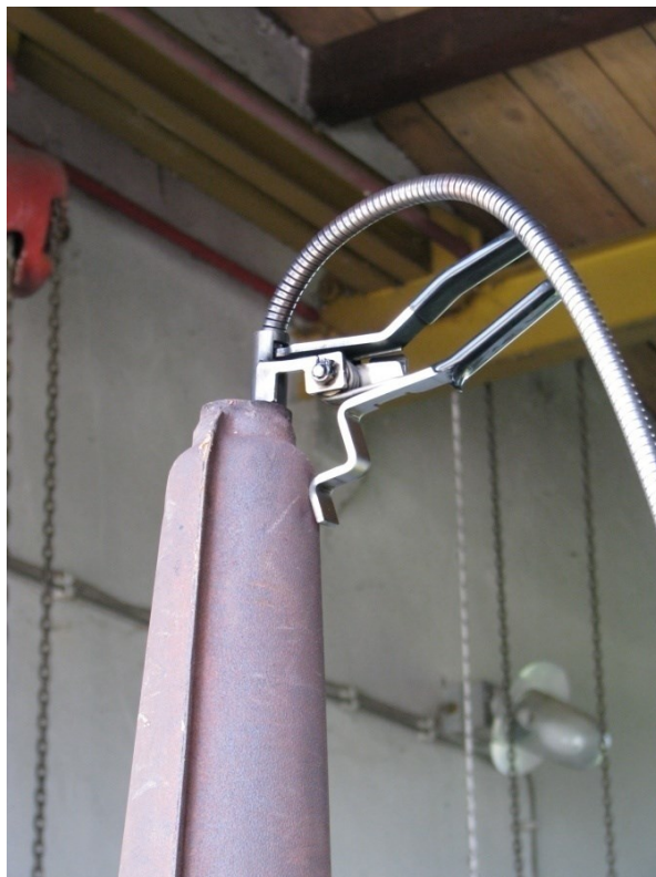
Slika 9. Mjerenje ispušnih plinova sondom analizatora (Izvor: Goran Fabijanić)
