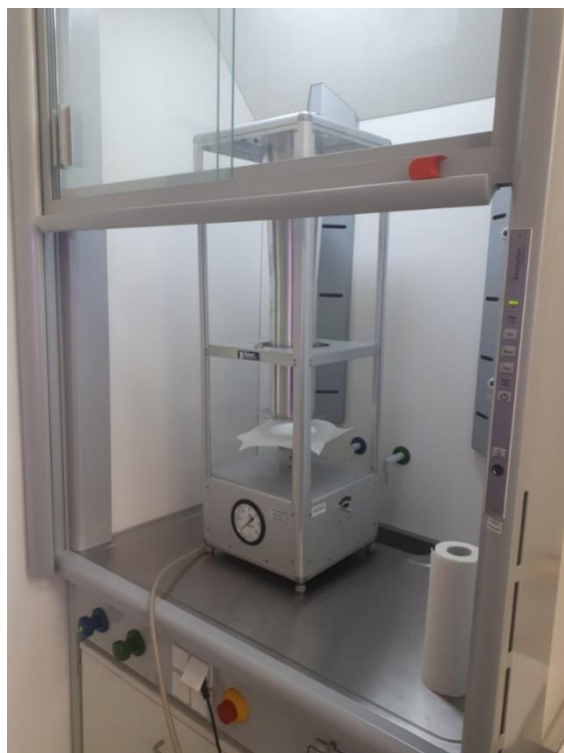
Slika 3.4.1.2. Potter spray tower- uređaj za preciznu primjenu tretmana
