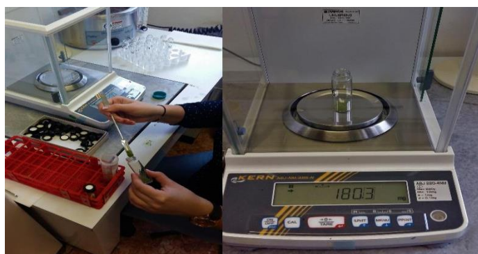
Slika 4.4. Vaganje usitnjenih uzoraka (izvor: M. Žarak)
