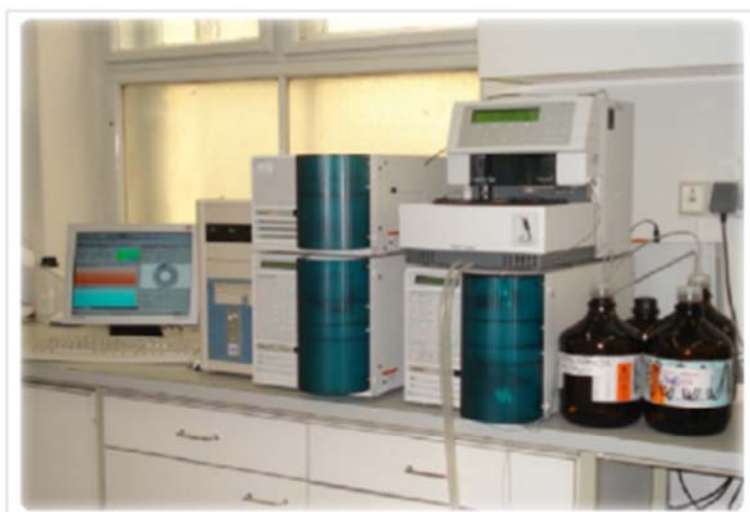
Slika 11. Tekućinski kromatograf visoke djelotvornosti, Varian ProStar 500, s detektorom s nizom dioda (HPLC - DAD)
