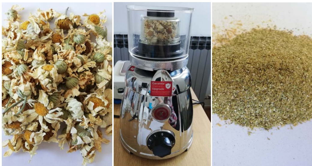
Slika 12. Postupak usitnjavanja osušenih cvatnih glavica buhača
