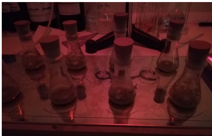
Slika 14. Ekstrakcija maceracijom u tamnoj komori
