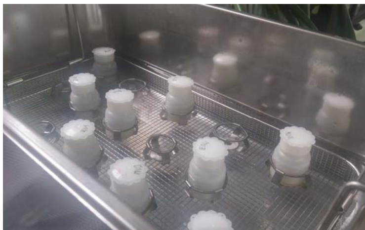
Slika 13. Postupak ekstrakcije ultrazvukom
