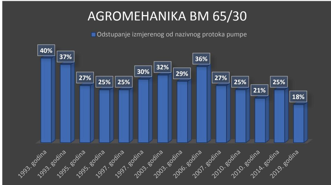
Graf 7.7. Postotak odstupanja izmjereno od nazivnog protoka pumpe kod svih ispitanih uređaja marke Agromehanika sa BM 65/30 pumpom
