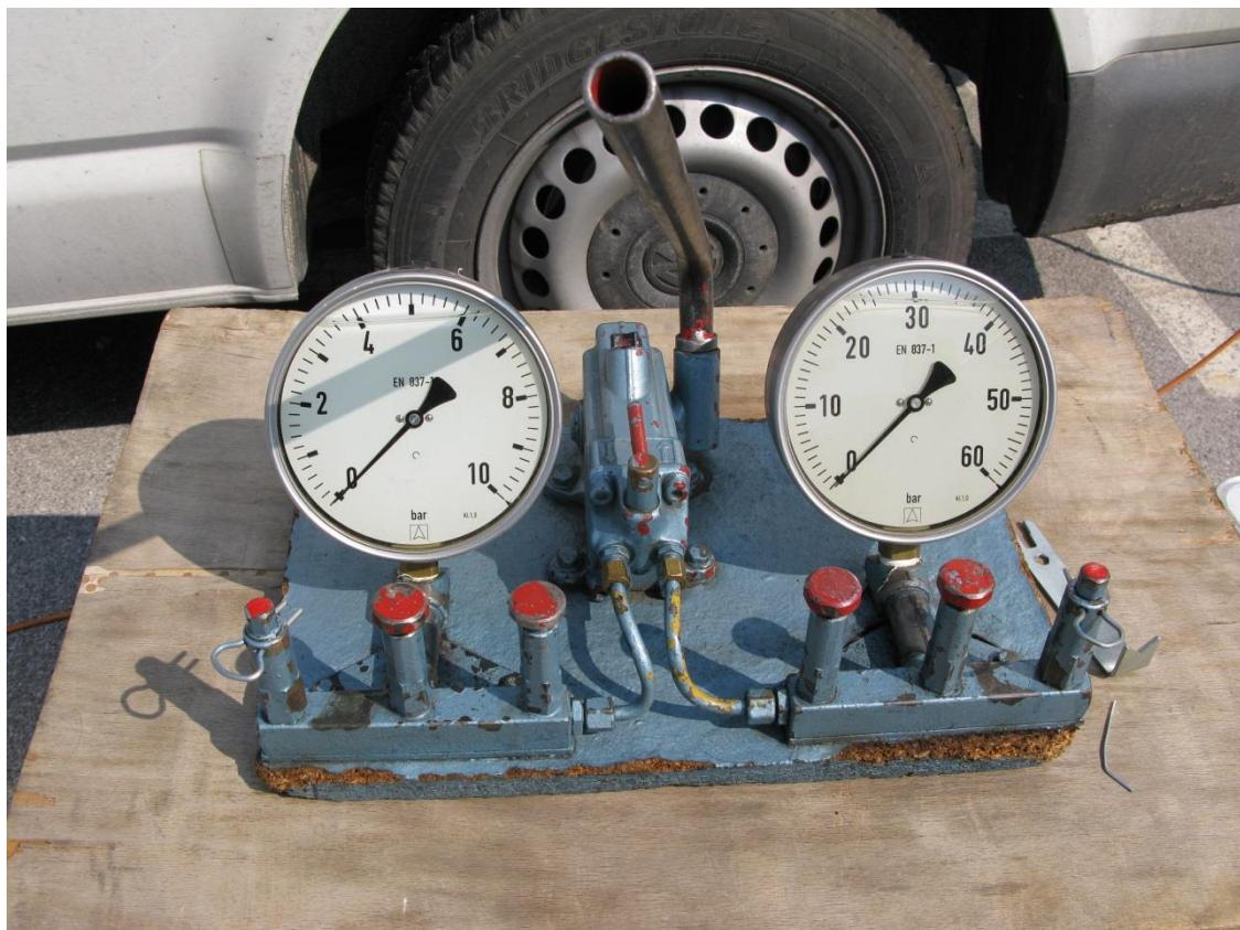
Slika 4.2. Mehanički uređaj za kalibraciju manometra
