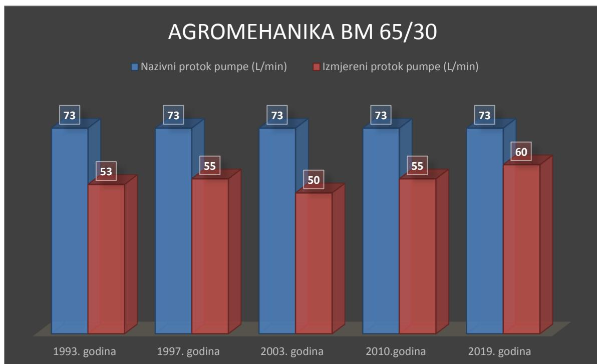
Graf 7.5. Odnos nazivnog i izmjerjenog protoka pumpe s obzirom na starost uređaja kod BM 65/30 pumpe marke Agromehanika
