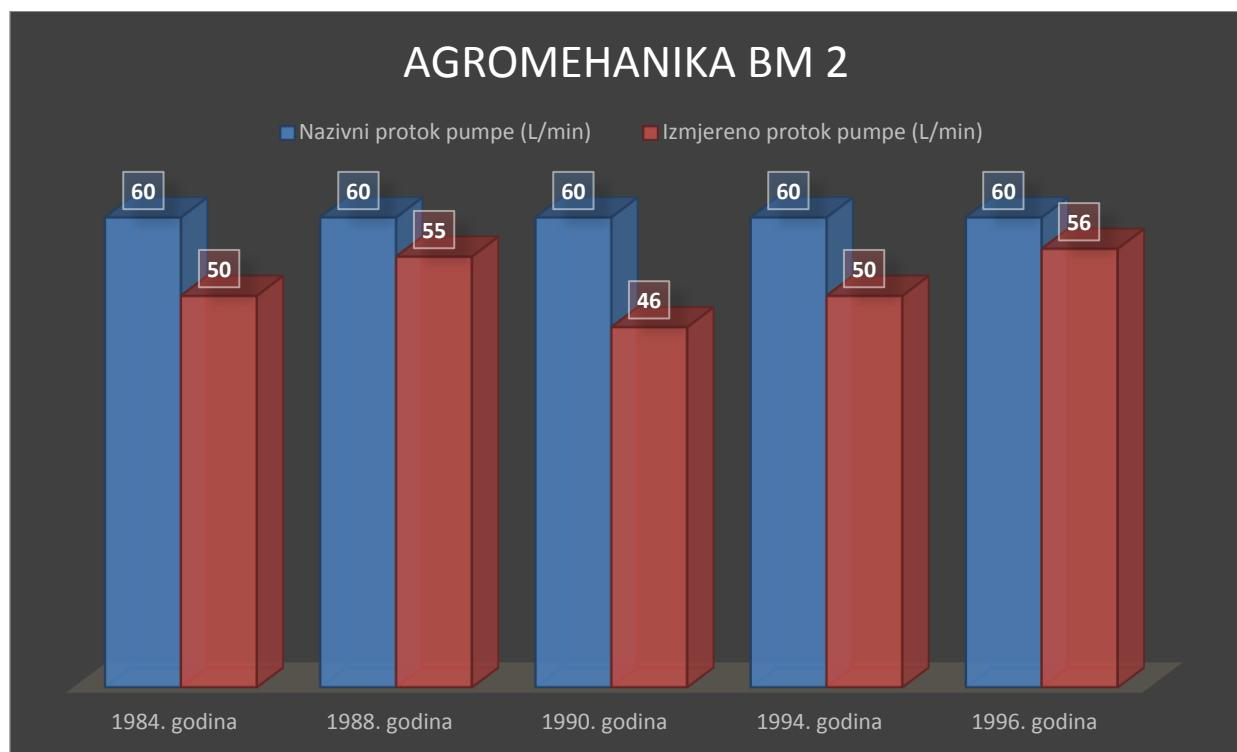
Graf 7.2. Odnos nazivnog i izmjerjenog protoka pumpe s obzirom na starost uređaja kod BM 2 pumpe marke Agromehanika
