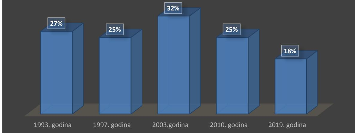
Graf 7.6. Postotak odstupanja izmjereno od nazivnog protoka pumpe kod BM 65/30 pumpe marke Agromehanika
