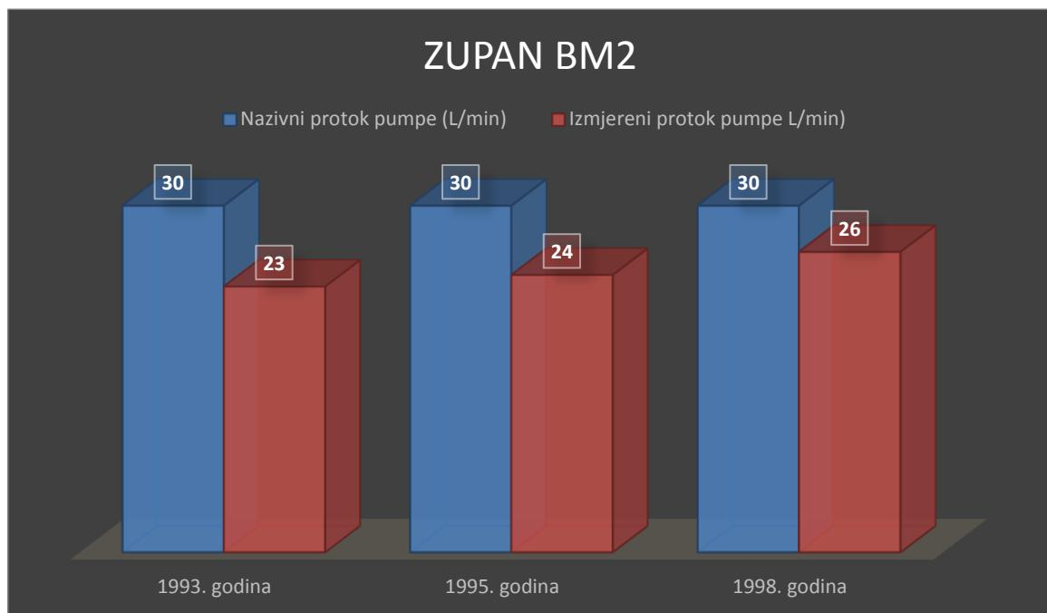
Graf 7.10. Odnos nazivnog i izmjerenoj protoka pumpe s obzirom na starost uređaja kod BM 2 pumpe marke Zupan
