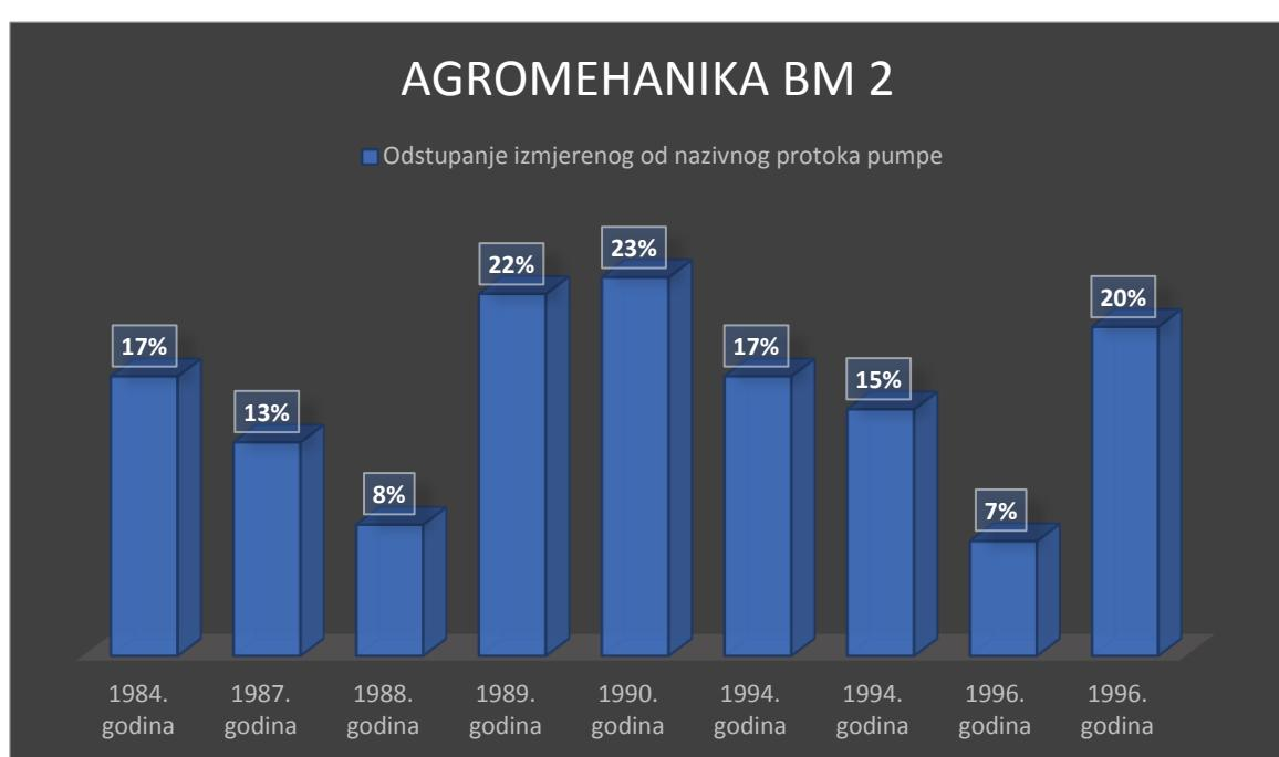
Graf 7.4. Postotak odstupanja izmjereno od nazivnog protoka pumpe kod svih ispitanih uređaja marke Agromehanika sa BM 2 pumpom
