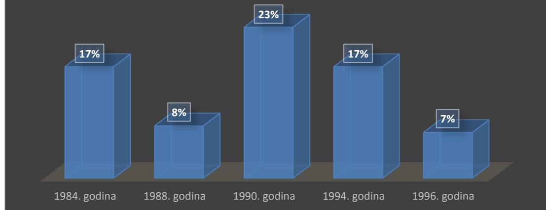
Graf 7.3. Postotak odstupanja izmjereno od nazivnog protoka pumpe kod BM 2 pumpe marke Agromehanika
