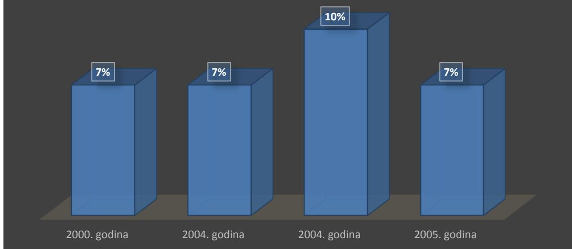
Graf 7.9. Postotak odstupanja izmjereno od nazivnog protoka pumpe kod svih ispitanih uređaja marke Zupan sa AR 30 pumpom
