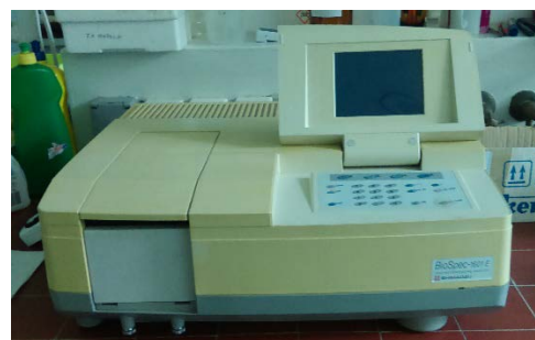
Slika 3.1.5. Shimadzu BioSpec-1601 E UV- Vis spektrofotometar
