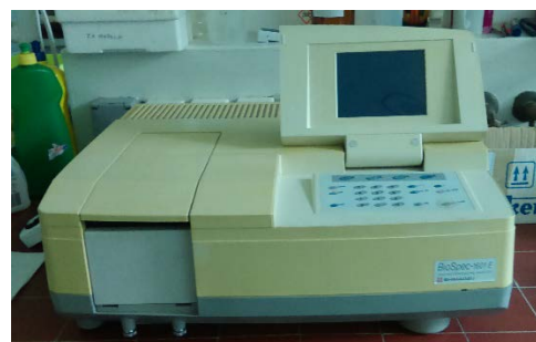
Slika 3.1.5. Shimadzu BioSpec-1601 E UV- Vis spektrofotometar
