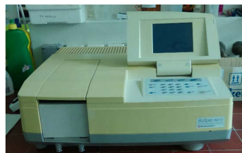
Slika 3.1.5. Shimadzu BioSpec-1601 E UV- Vis spektrofotometar
