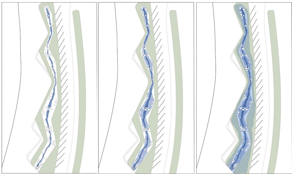
Slika 25. Shematski prikaz plavljenja kanala (Izvor: Autor)
