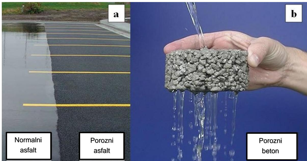
Slika 7. Usporedba normalnog i propusnog asfalta i prikaz propusnog betona
