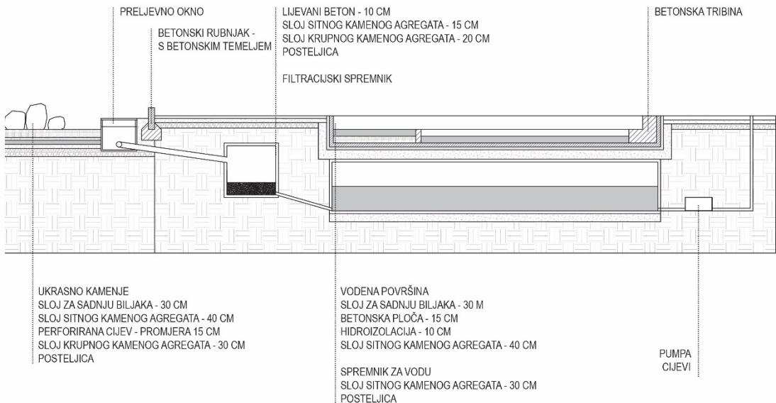
Slika 29. Tehnički presjek sakupljanja kišnice i vodene površine (Izvor: Autor)
