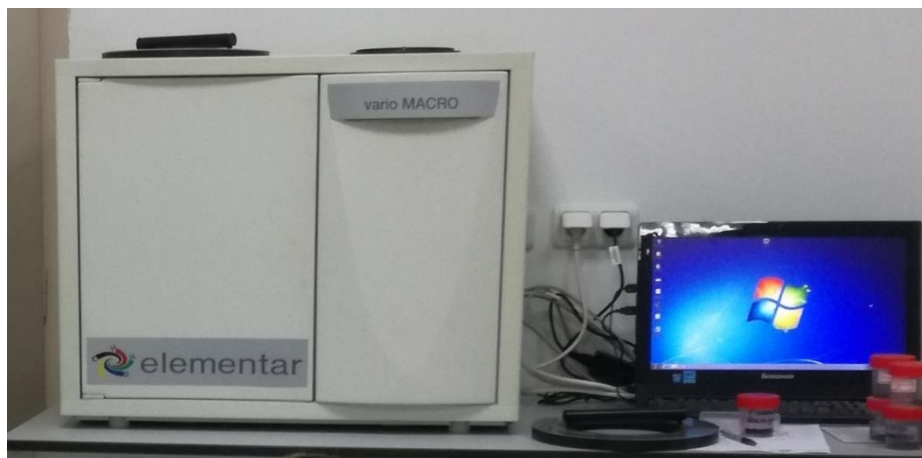
Slika 20. Macro CHNS analizatora (Analysensysteme GmbH, Njemačka) (Izvor: Vlastiti)
