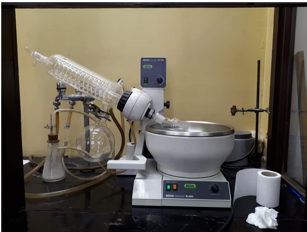
Slika 4.2.3. Uparivač Büchi Waterbath B-480
