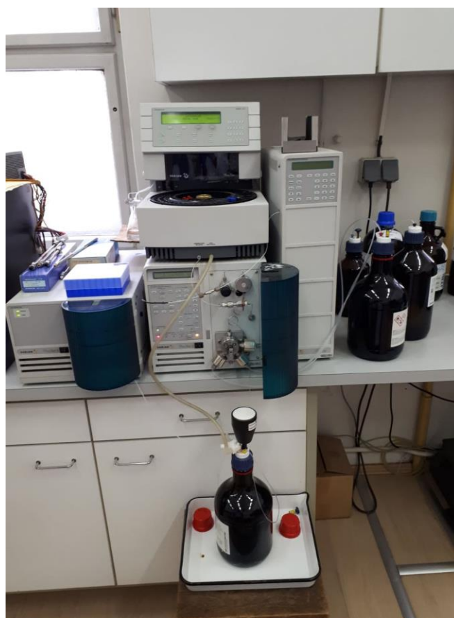
Slika 4.3.1. Varian ProStar 500 HPLC sustav
