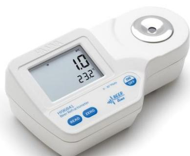
Slika 6. Digitalni defraktometar
