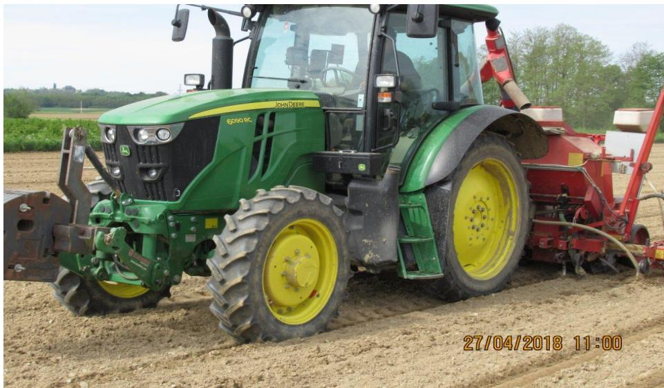
Slika 4. Vođenje traktora kotačem po tragu markera (snimio Igor Kovačev)
