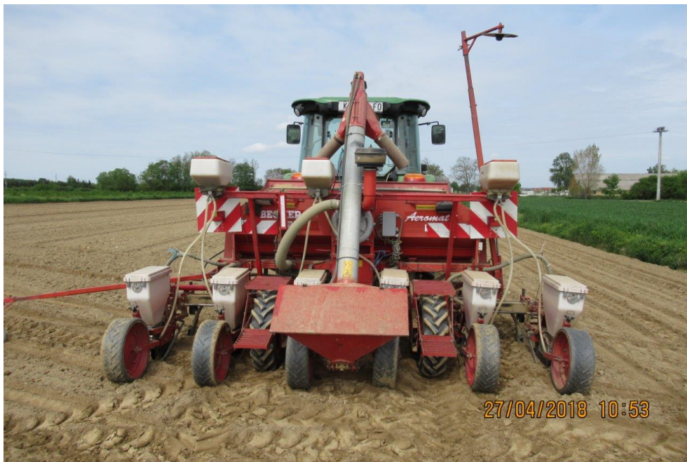
Slika 8. Sijačica Becker Aeromat T (snimio Igor Kovačev)
