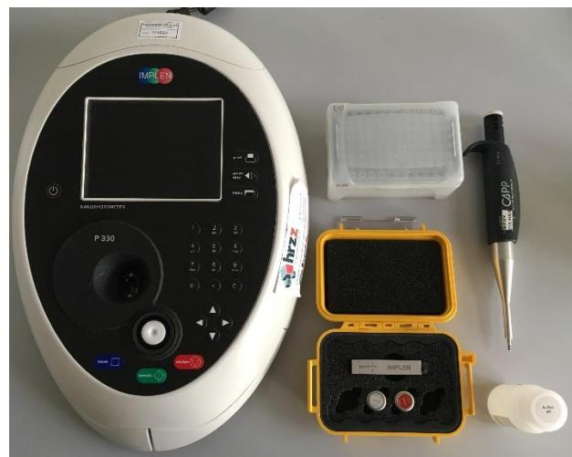
Slika 11. Uredaj NanoPhotometer P330 Spektrofotometer (IMPLEN, Njemačka) za mjerjenje koncentracije DNA (Brajković, 2018).
