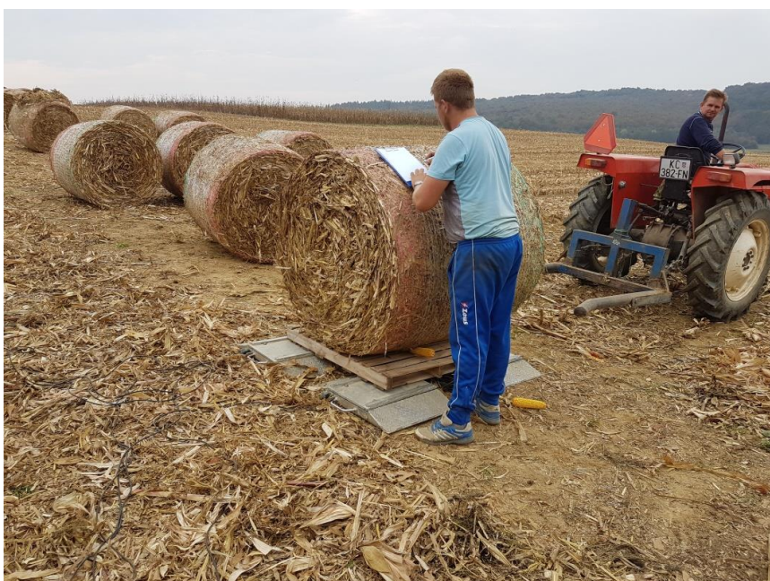
Slika 37. Vaganje bala i zapisivanje podataka
