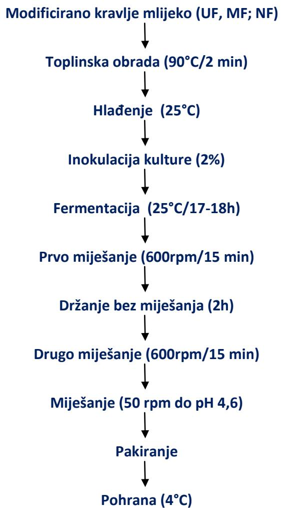
Slika 10: Shematski prikaz proizvodnje kumisa od modificiranog kravljeg mlijeka.
