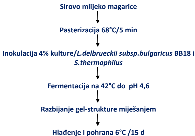
Slika 12: Shematski prikaz tehnološkog postupka proizvodnje jogurta od mlijeka magarice.
