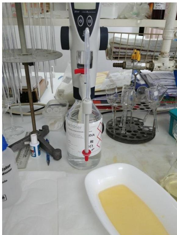
Slika 3. Aparatura za određivanje ukupne kiselosti
