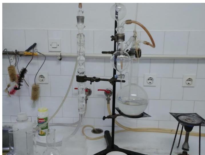
Slika 4. Aparatura za određivanje hlapive kiselosti
