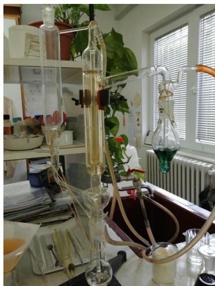
Slika 6. Aparatura za određivanje sumpora u vinu
