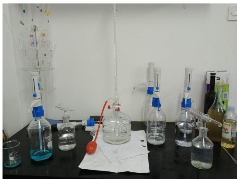
Slika 2. Aparatura za određivanje reducirajućeg šećera
