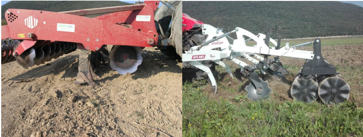
Slika 25. Različiti tipovi kultivatora u kombinaciji s tanjuračom (Raša)
