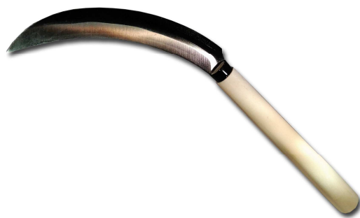
Slika 9. Nož za ručnu žetvu cvata lavande i lavandina (izvor: http://www.zenportindustries.com/ )
