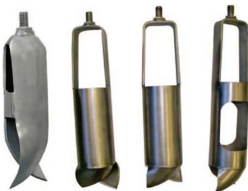
Slika 41: Različite izvedbe obalnog svrdla za skeletno (lijevo), pjeskovito, ilovasto i glinasto tlo (desno)
