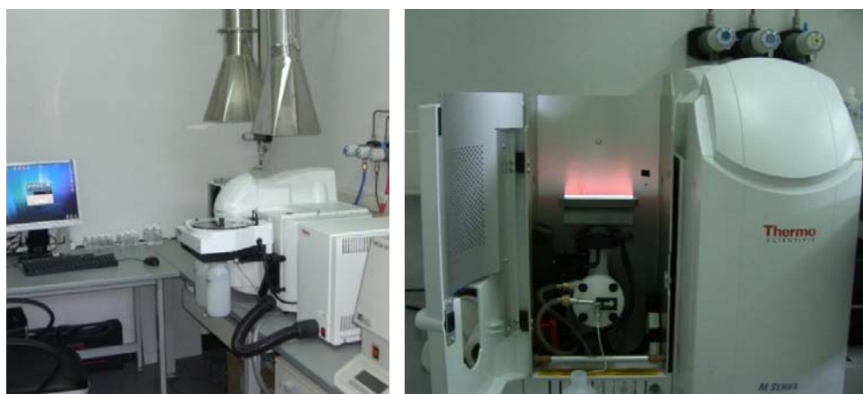
Slike 97: Atomski apsorpcijski spektrometar (AAS)
