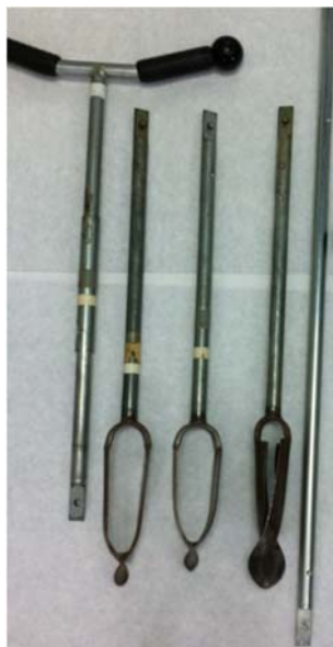
Slika 39: Edelmanova svrdla s T-nastavkom i radnim tijelom prilagođenim za uzorkovanje na glinovitim, ilovastim i pjeskovitim tlima
