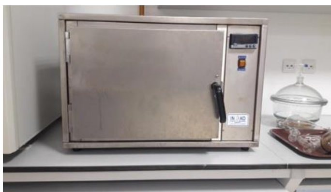
Slika 3.2.2.1. Laboratorijski sušionik INKO
