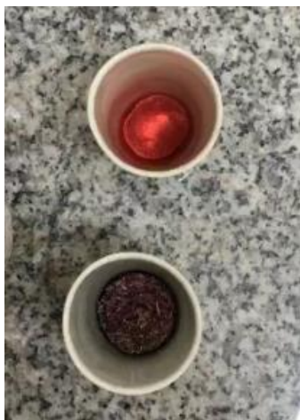
Slika 3.2.4.1. Koks nakon spaljivanja u mufolnoj peći
