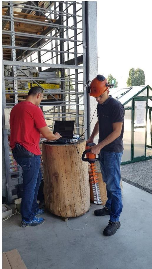
**Slika 8.** – Položaj rukovatelja pri mjerenu vibracija koje se prenose s uređaja na sustav šaka – ruka prema preporukama ISO 7505
