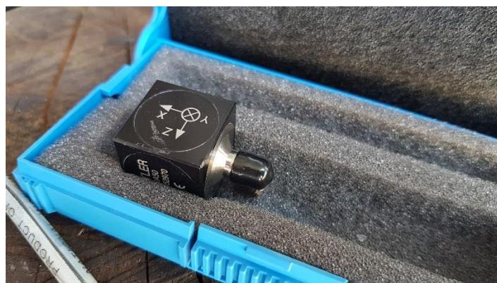
**Slika 9.** - Troosni akcelerometar tip 8762A10
