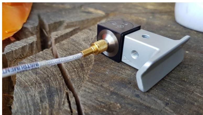
**Slika 7.** – Troosni akcelerometar TIP 8762A10
