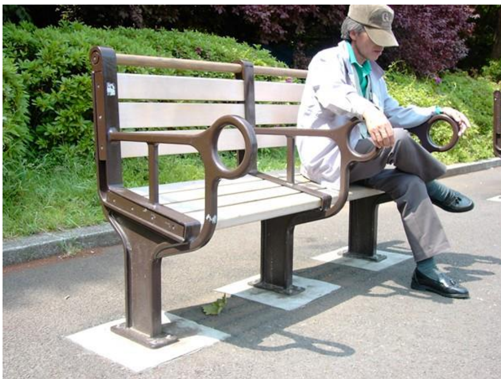
Slika 2.4.3 Anti-dizajn klupe (2006), Tokio Poprečni nasloni za ruke, nagib plohe za sjedenje, okomiti naslon za leđa Izvor: http://image.ohmynews.com/down/images/1/yumiko_321234_1[528575].jpg
