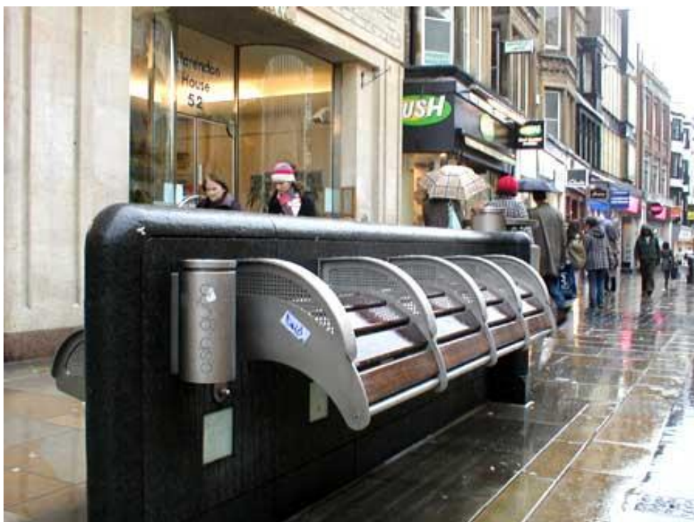
Slika 2.4.3 Anti-dizajn klupe, Oxford Poprečni nasloni za ruke, zaobljenost plohe za sjedenje, visina površine za sjedenje Izvor: https://urbanshit.de/bilder_urbanshit/2014/06/anti-homeless-spikes-940x517.jpg
