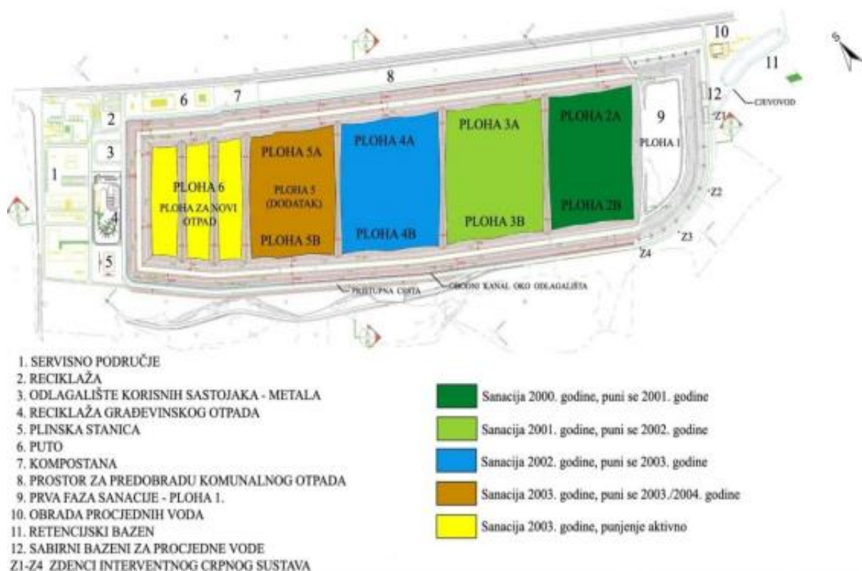
Slika 61: Tijek sanacije i tehnički objekti odlagališta otpada Jakuševac-Prudinec (Drnjević i Koren, 2000.)
