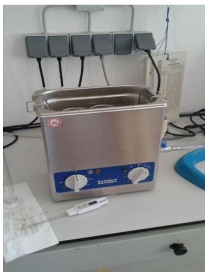
Slika 15. Ultrazvučna kupelj “Bandelin” RK 103H
