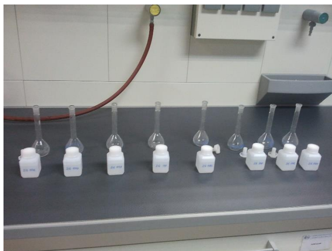
Slika 20. Staklene tikvice i plastične posude u koje su kvantitativno prenešeni uzorci nakon mokrog spaljivanja (2017)
