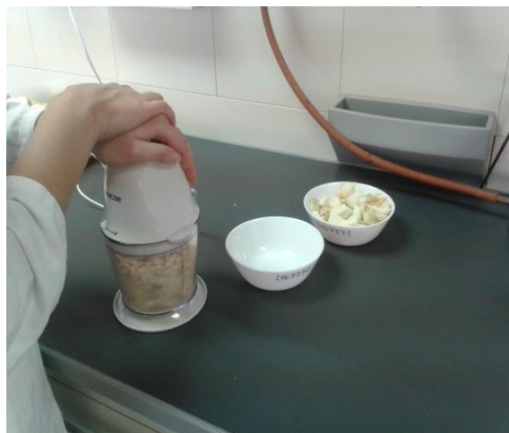
Slika 12. Usitnjavanje uzorka u sjeckalici
