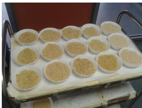
Slika 15. Uzorci pripremljeni za sušenje na 105°C Slika 16. Termostat
