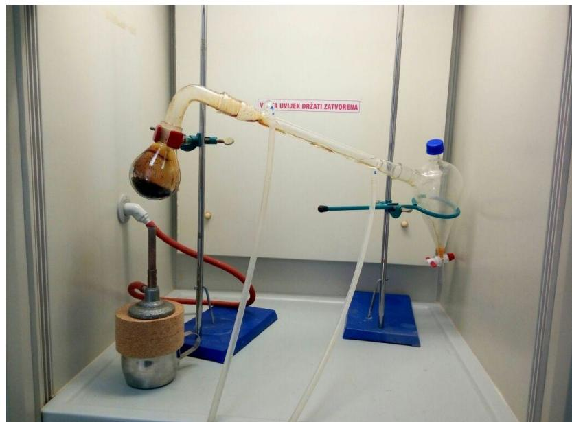
Slika 11. Sustav za provođenje laboratorijskog procesa pirolize
