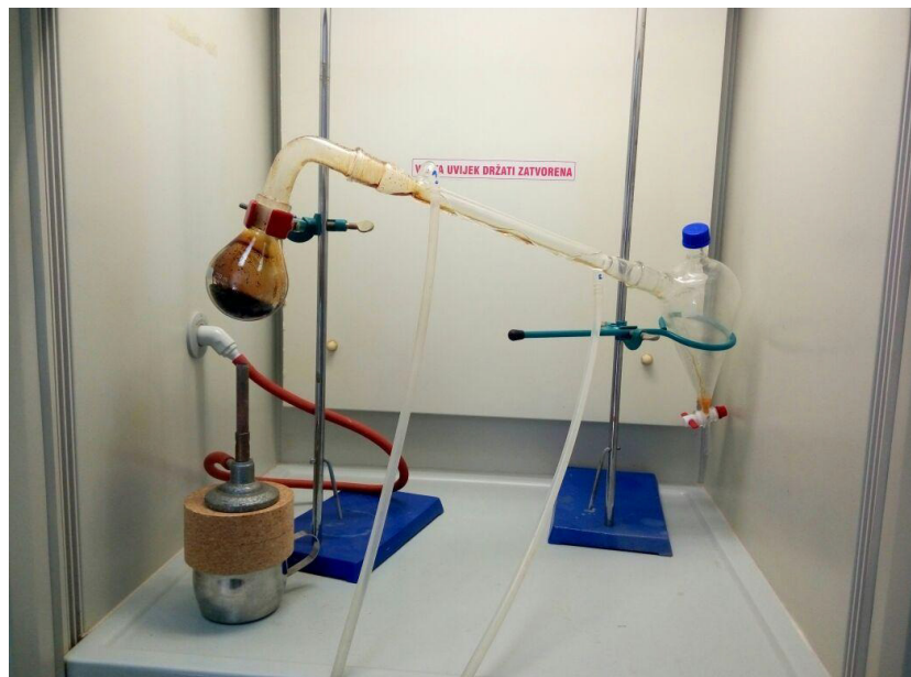
Slika 11. Sustav za provođenje laboratorijskog procesa pirolize
