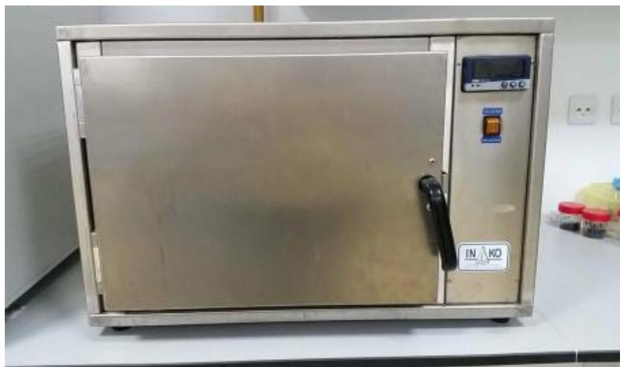
Slika 4.1. Prikaz laboratorijskog sušionika
