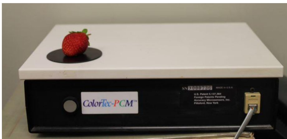
Slika 3.4.4.1. Određivanje boje ploda jagode
