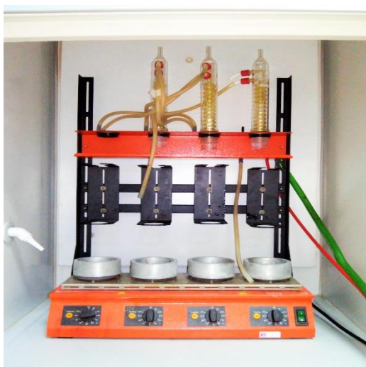
Slika 8. Soxhlet aparat (snimila: T. Mavričić)
