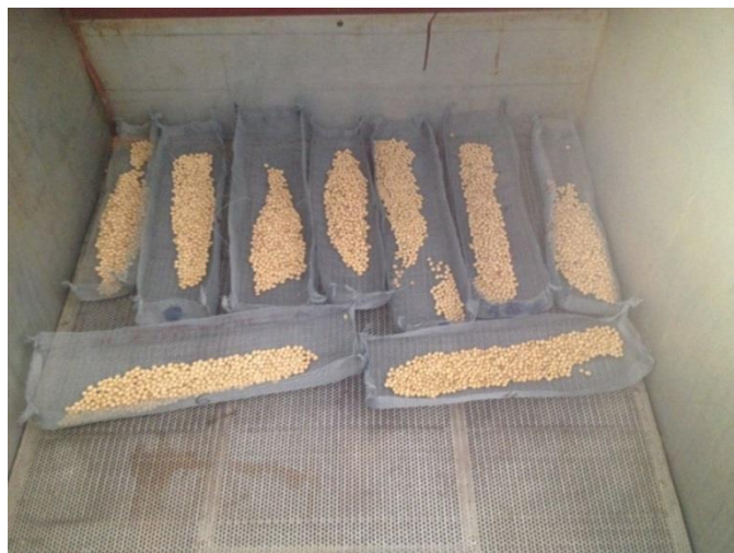
Slika 22: Tostiranje soje u laboratorijskom tosteru (izvor: vlastiti)
